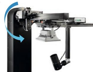
▲ Abb. 3: Mit Hilfe eines Auslegers wird der Prüfling in die vorgesehene Brennlage positioniert und der Referenzwert für die Lagekorrektur wird aufgenommen.
