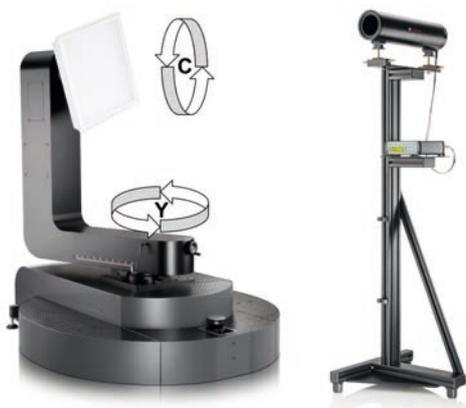
▲ Abb. 1: Leuchtenwender LGS 1000 (links) und Streulichttubus mit dem Detektor (Photometerkopf oder EOP) auf einem Ständer (rechts).
