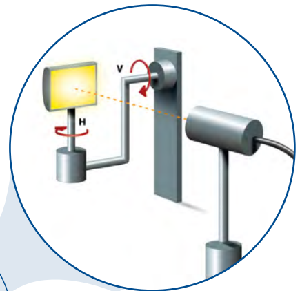
Drehrichtungen eines Typ A-Goniometers.
