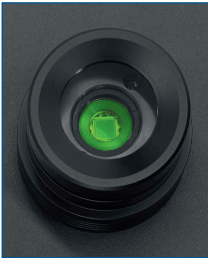
► Photometerkopf DSP 200: V(\lambda) -Filter.
