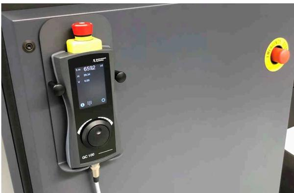
▲ Mit dem stabilen Metallhalter lässt sich GC 100 am Goniometergehäuse, Schaltschrank oder der Laborwand befestigen.
