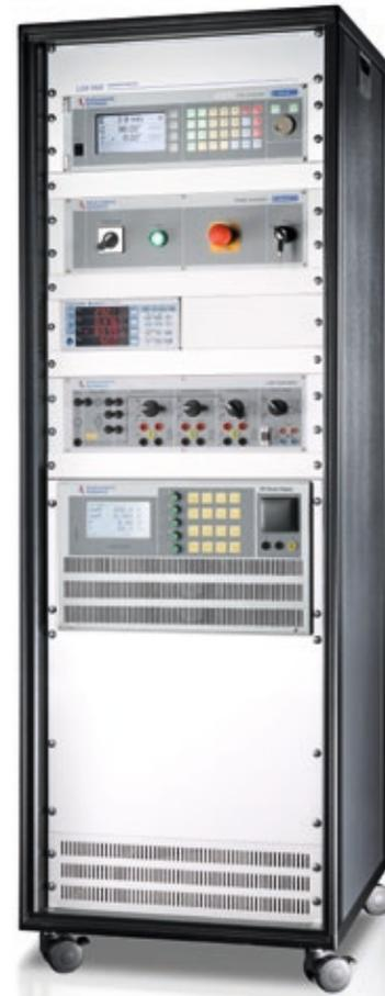
Schaltschrank mit Steuereinheit, Prüflingsstromversorgung und Leistungsmessgerät
