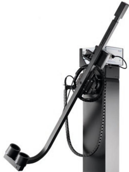
Lichtstromintegrator mit Photometer und Spektralradiometer
