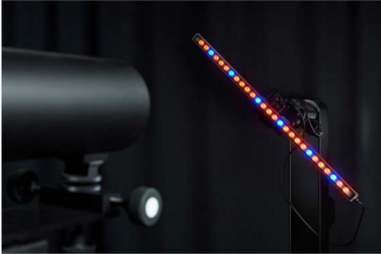
**Abbildung:** Die Teilnehmer lernen u.a. typische Fehlerquellen in der Goniophotometrie kennen. Dazu gehören das korrekte Einbrennen der Lichtquelle, präzise Messung des Abstandes zwischen Detektor und Lichtquelle und ein Messlabor mit guter Fremdlichtunterdrückung.
