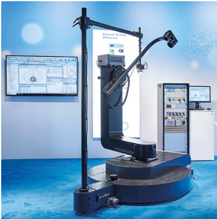
Abbildung: Um Abstrahlcharakteristik und Lichtstrom einer SSL-Quelle präzise zu bestimmen, werden mit einem LGS Goniometersystem winkelabhängige Eigenschaften umfassend charakterisiert.
